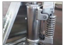
オールステンレス仕様 油圧ユニットの細部までステンレス。
